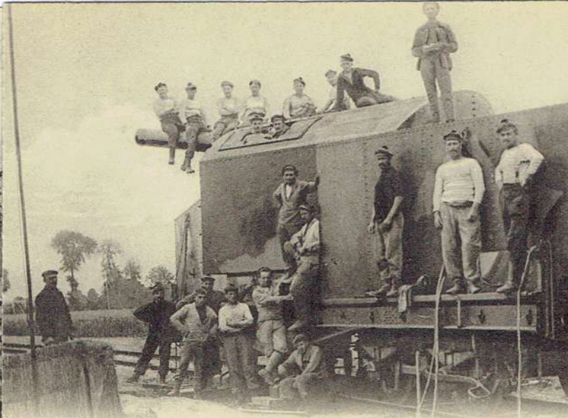
837 GUERRE 1914-1916. — Bataille de la Somme. — Piece de 194 sur voie ferrée. Gun of 194 on the railway. Visé Paris n° 837
